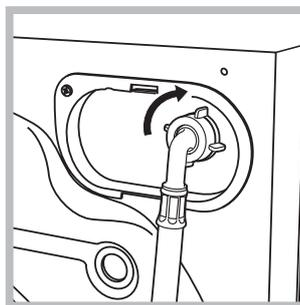
2. Подсоедините водопроводный шланг к машине, привинтив его к специальному водопроводному крану, расположенному в задней верхней части справа (см. схему).
