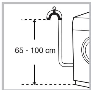
Подсоедините сливной шланг, не перегибая его, к сливной трубе или к настенному сливному отверстию, распложенному на высоте от 65 до 100 см от пола,
